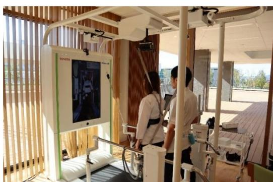
(図 105) 「歩行練習支援型ロボット Welwalk WW-1000」
